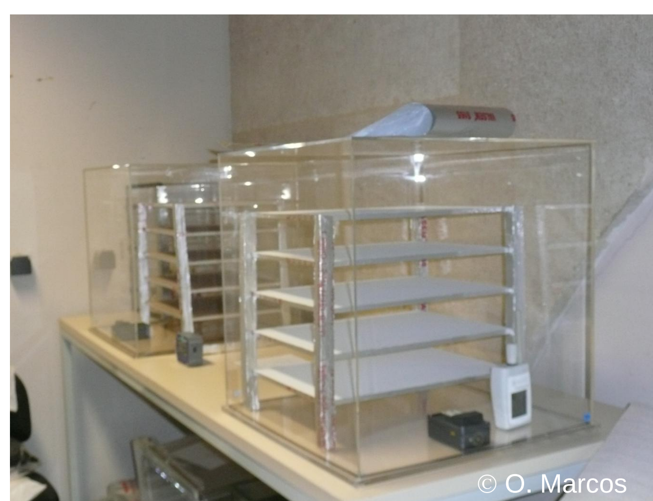
Photo 1: Mesure de la vitesse de corrosion en temps réel à l'aide d'un enregistreur AirCorr et d'une piste en plomb (résultats sur la Fig. 3).
